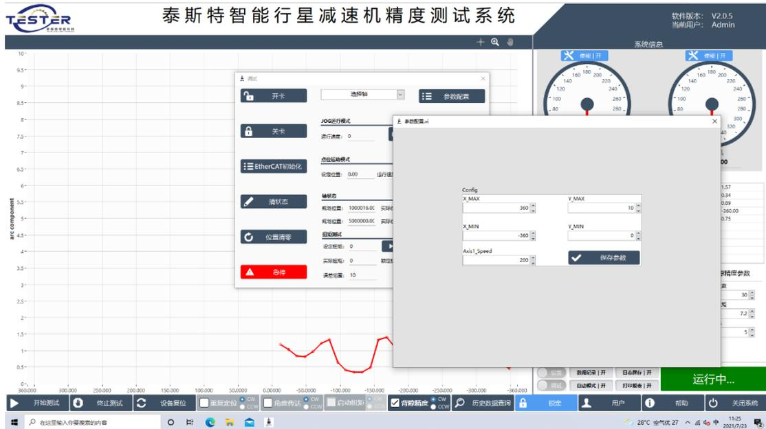
在调试界面，参数设置里可以设置保存 X/Y 坐标的最小值最大值，此设置可做默认保存用，也可直接更改坐标上的数值，但只用于零时显示
