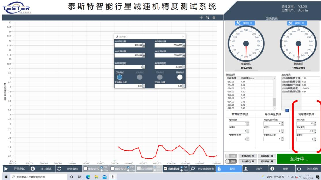
在此框架内输入减速机的测试次数，默认推荐 30 次，测试扭矩，推荐按照减速机输出额定扭矩 2%，减速机的减速比
